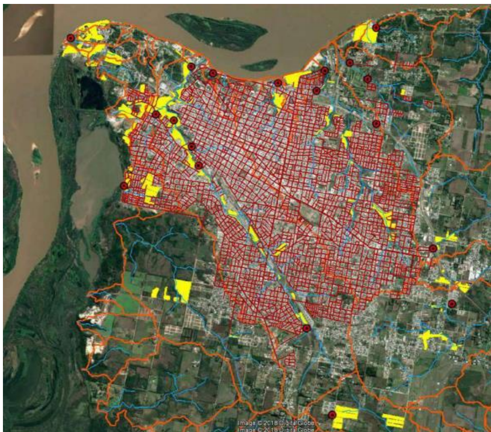
Mapa 1. Red cloacal (líneas rojas), asentamientos irregulares (polígonos amarillos) y Estaciones Elevadoras (puntos rojos).
