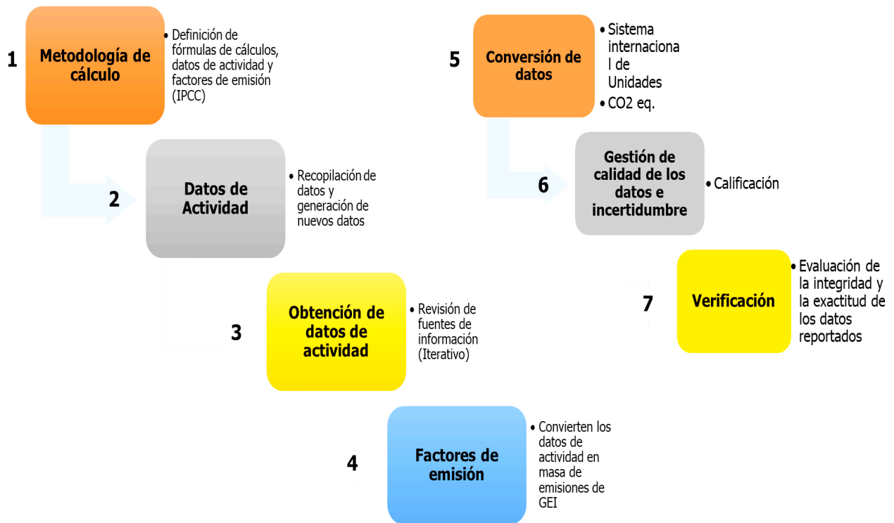
Figura 7 Pasos para el cálculo de Inventarios Locales de GEI Elaboración Propia sobre la base del GPC, 2017
