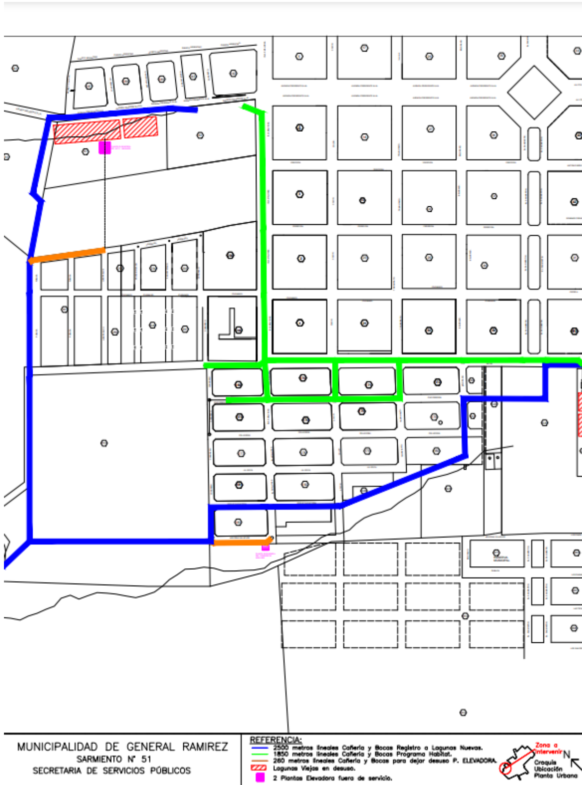
Ilustración 28. Ampliación de la red cloacal.
